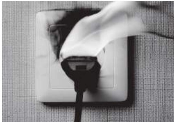
множественные циклы нагрева и остывания делают деформацию проводника критичной. В месте зажима он становится тоньше. Так же от нагрева провод окисляется и в месте соединения возрастает сопротивление. Появляется плохой контакт, что при дальнейшей перегрузке приводит - перегреву и возгоранию.
