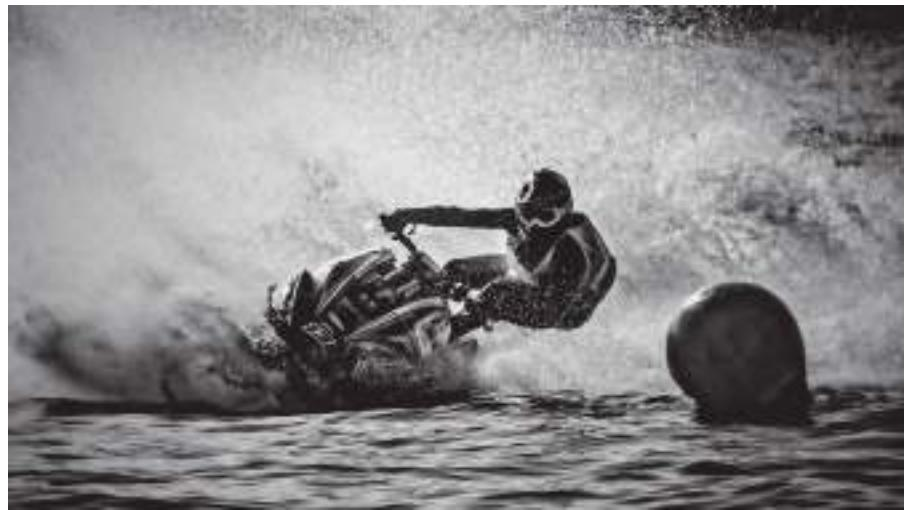
При пересечении волнового следа от прошедшего судна водителю гидроцикла следует снизить скорость гидроцикла.
